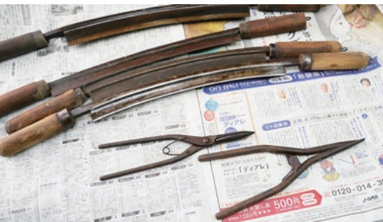
▲皮をなめす「セン刀」(上段)と狭い穴を開くための道具(下段)。これらは特注品だ(2023年2月6日)
